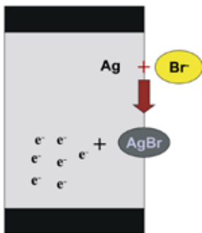
Abb. 5 Anodenreaktion bei der Silberelektrode
